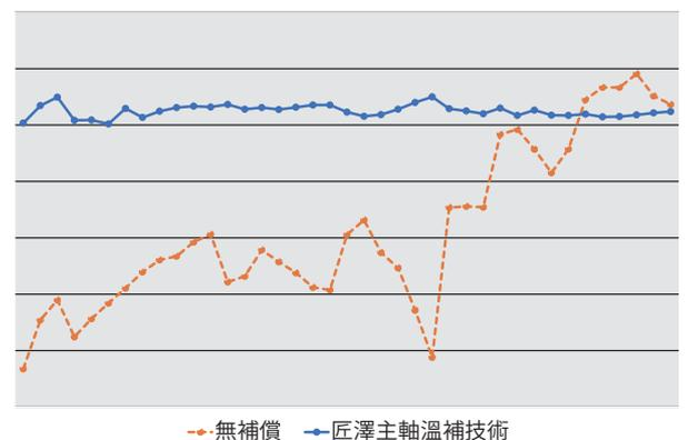
無主軸溫補，不同區塊間的接縫明顯。導入匠澤主軸溫補技術後，切削後的工件因誤差極小，接縫間較不明顯，段差小。
